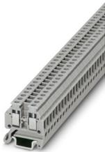
Micro-bloc, tension nominale: 400 V, intensité nominale: 17,5 A, nombre de connexions: 2, type de raccordement: Raccordement vissé, Section de référence: 1,5 mm<sup>2</sup>, section : 0,14 mm<sup>2</sup> - 1,5 mm<sup>2</sup>, type de montage: NS 15, coloris: gris
