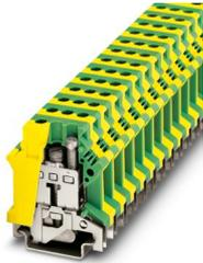
Bloc de jonction pour conducteur de protection, En cas de juxtaposition avec des blocs de jonction traversants de même forme, un couvercle doit être inséré si les tensions d'isolement sont  $> 690$  V., nombre de connexions: 2, nombre de pôles: 1, type de raccordement: Raccordement vissé, Section de référence:  $16 \text{ mm}^2$ , section :  $2,5 \text{ mm}^2 - 25 \text{ mm}^2$ , type de fixation: Pied PE avec vis de fixation, M4, type de montage: NS 35/7,5, NS 35/15, NS 32, coloris: vert/jaune
