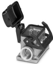
Embase en saillie B6, avec étrier longitudinal, matériau: Aluminium coulé sous pression, résistant à l'eau de mer, matériau du couvercle de protection: PC, nombre de sorties: 2, latérale, 2x M20, hauteur: 54,6 mm, presse-étoupe: sans, capot de protection: oui, Standard
