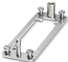
Cadre d'arrimage pour racks, pour éléments de contact de type B24, avec 4 vis à tête plate M5, insert de compensation axes x/y  $\pm 1,5$  mm
