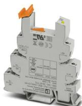
Module de base PLC de 14 mm pour courants permanents élevés avec raccordement vissé, sans relais ni relais à semi-conducteurs, pour montage sur profilé NS 35/7,5, 1 contact inverseur, tension d'entrée 24 V DC
