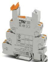
Module de base PLC de 14 mm pour courants permanents élevés avec raccordement Push-in, sans relais ni relais à semi-conducteurs, pour montage sur profilé NS 35/7,5, 1 contact inverseur, tension d'entrée : 24 V DC
