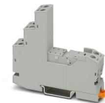
Embase de relais RIF-1..., pour relais de puissance miniatures avec 1 ou 2 contacts inverseurs ou relais à semi-conducteurs similaires, raccordement vissé, enfichabilité pour modules d'entrée/antiparasite, montage sur NS 35/7,5
